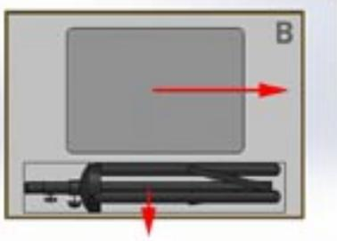
2. Löse nun beide Rändelschrauben am Stativ ziehe es auseinander bis die Beine die maximale Standbreite haben.
